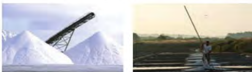
شکل ۱۳- استخراج و جداسازی سدیم کلرید به روش تبلور
